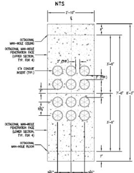
SECTION A-A (TYPICAL 4 SIDES)
